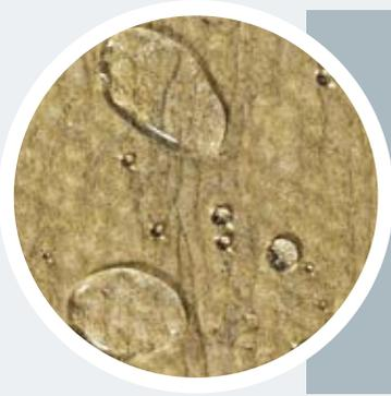
Η μη υγροσκοπικότητα και η χαμηλή απορρόφηση νερού ( $WS < 1 \text{ kg/m}^2$ ), η υψηλή διαπνοή ( $\mu = 1$ ) και η ανόργανη σύστασή του πετροβάμβακα (ορυκτό πέτρωμα), εξασφαλίζουν την άριστη συμπεριφορά στην ατμοσφαιρική υγρασία και τη **σταθερή ενεργειακή απόδοση του συστήματος σε όλη τη διάρκεια ζωής του κτηρίου.**
